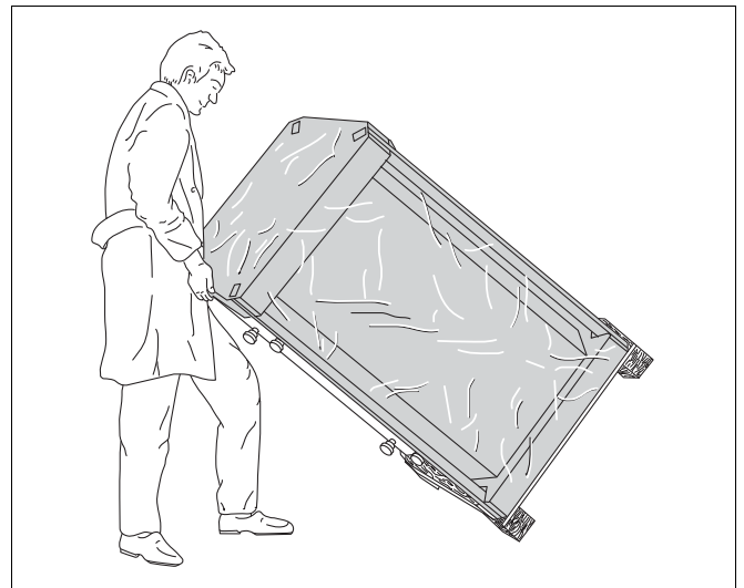
Sl. 4 Postavljanje bojlera za toplu vodu
